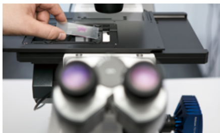
電動ステージの追加によってイメージングのスループットが劇的に向上します
