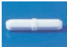
ピボットリングと同様に容器の底が平らでなくカーブしている場合にご使用ください
