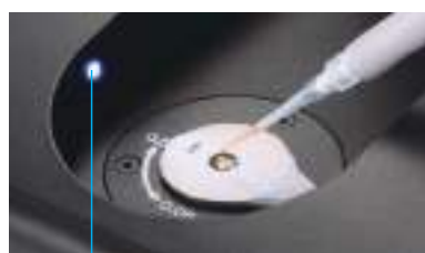
LEDアシストライトにより 溶液の滴下をサポート
