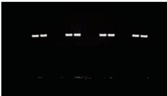
図2. サンプル抽出物の一部を、PCR試薬とヒト特異的プライマー、適切な実験コントロールとともにインキュベートした。反応を32サイクル実行し、ゲル電気泳動によりヒトDNAコンタミネーションを評価した。検証結果として、ヒトDNAレベルが1 pg未満であることを確認した。
